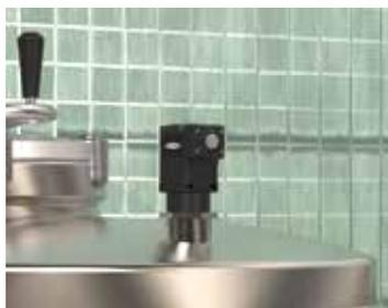
Capteur de température et d'humidité
