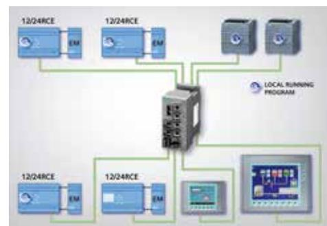
La toute dernière génération de modules logiques easyE4 est destinée à la commande des machines et des installations. L'easyE4 vient succéder aux séries easy500, easy700 et easy800 avec un nombre élevé d'entrées/sorties jusque 188 et ses larges plages de tensions 100-240 V AC/DC, 12/24 V DC, 24 V AC.
